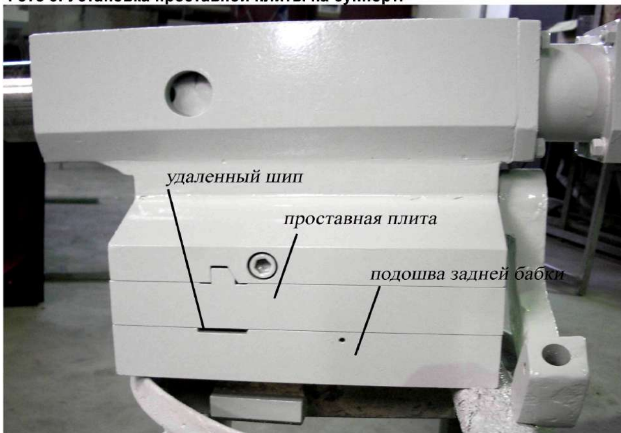
Фото 3. Установка проставной плиты на суппорт.
