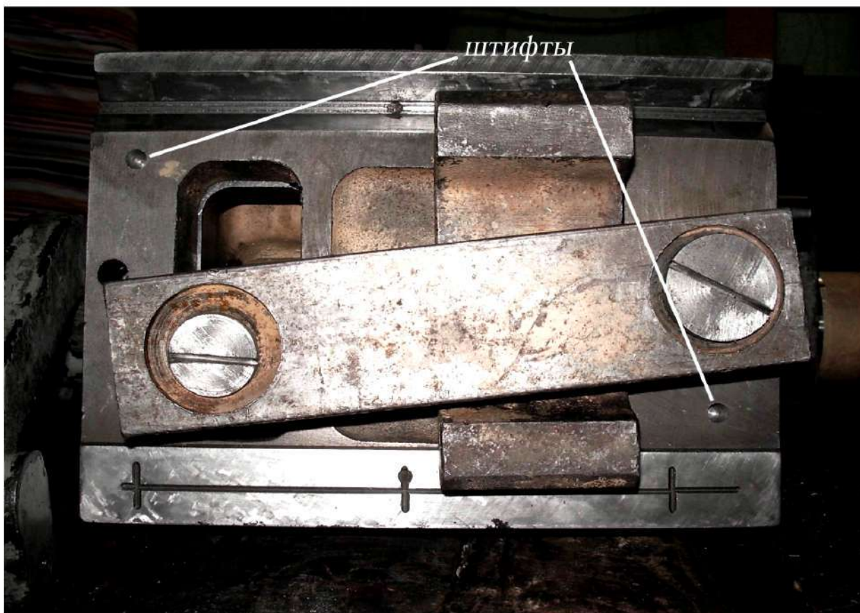
Фото 1. Задняя бабка. Вид снизу.
